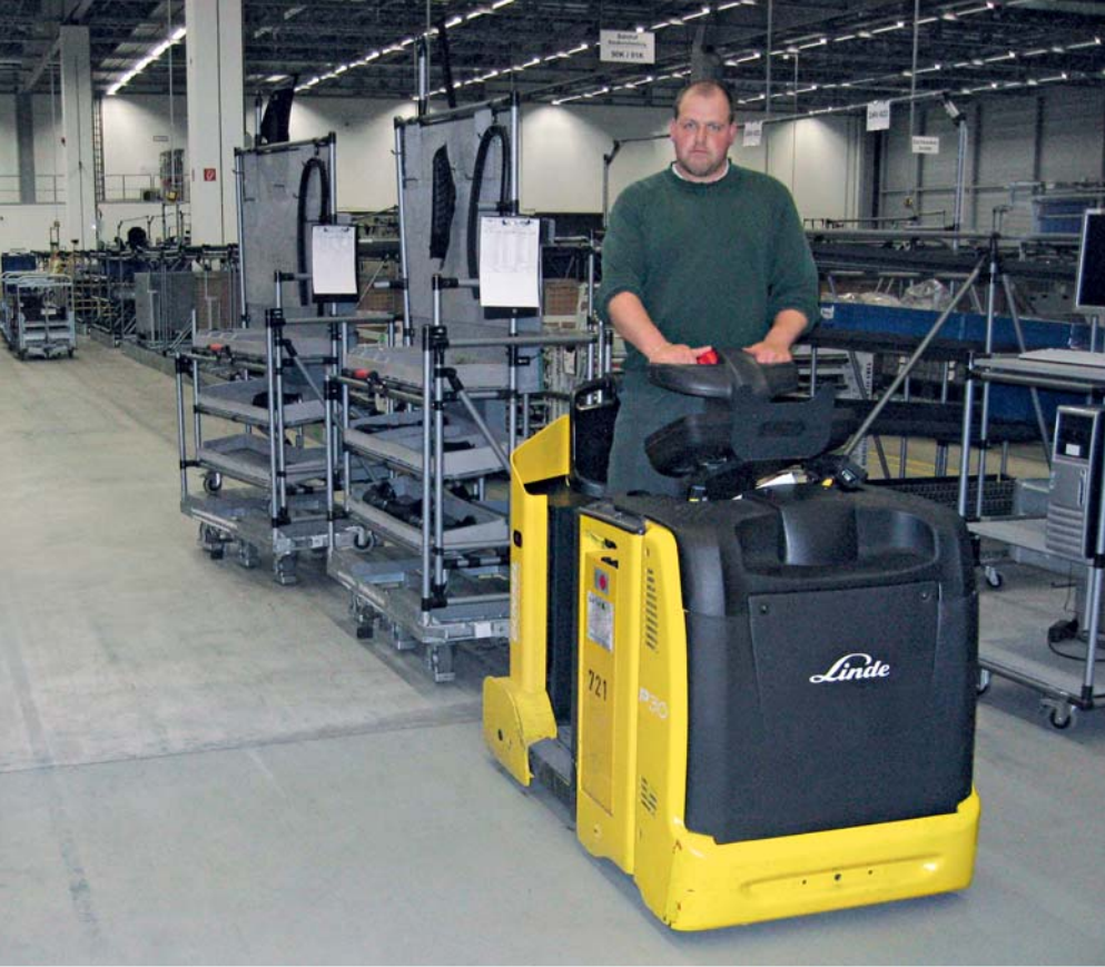
Die Fahrerstandschlepper, die bis zu drei Tonnen Last ziehen können, ersetzen im Logistikzentrum Leipzig die klassischen Stapler.
