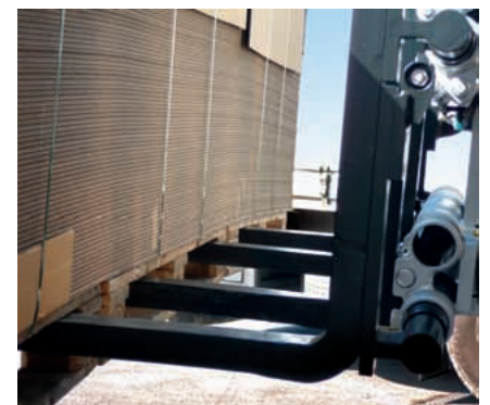
Ein Treibgasstapler H30 mit Doppelpalettenklammer kommt beim Verladen der fertigen Kartonstapel zum Einsatz.
