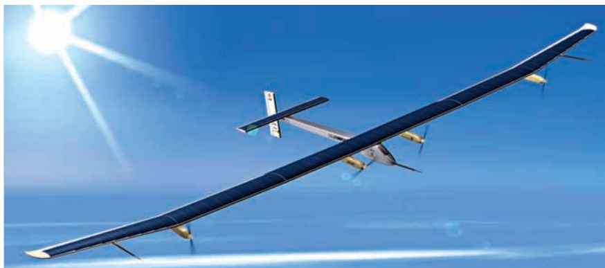
Angetrieben wird die „Solar Impulse“ von vier elektrischen 10-PS-Motoren, die aus der Energie von 11.628 Solarzellen gespeist werden. Trotz seiner Spannweite von 63,40 Metern, was in etwa der eines Airbus A-340 entspricht, wiegt das Flugzeug nur 1.600 Kilogramm.
