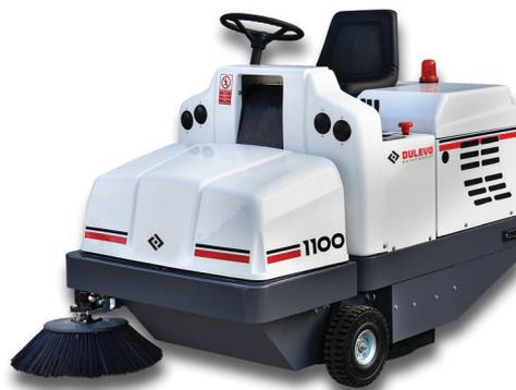
Die DULEVO Futura 1100 ist eine selbstfahrende Industrie-Kehrsaugmaschine für den leichten bis mittelschweren Einsatz.
