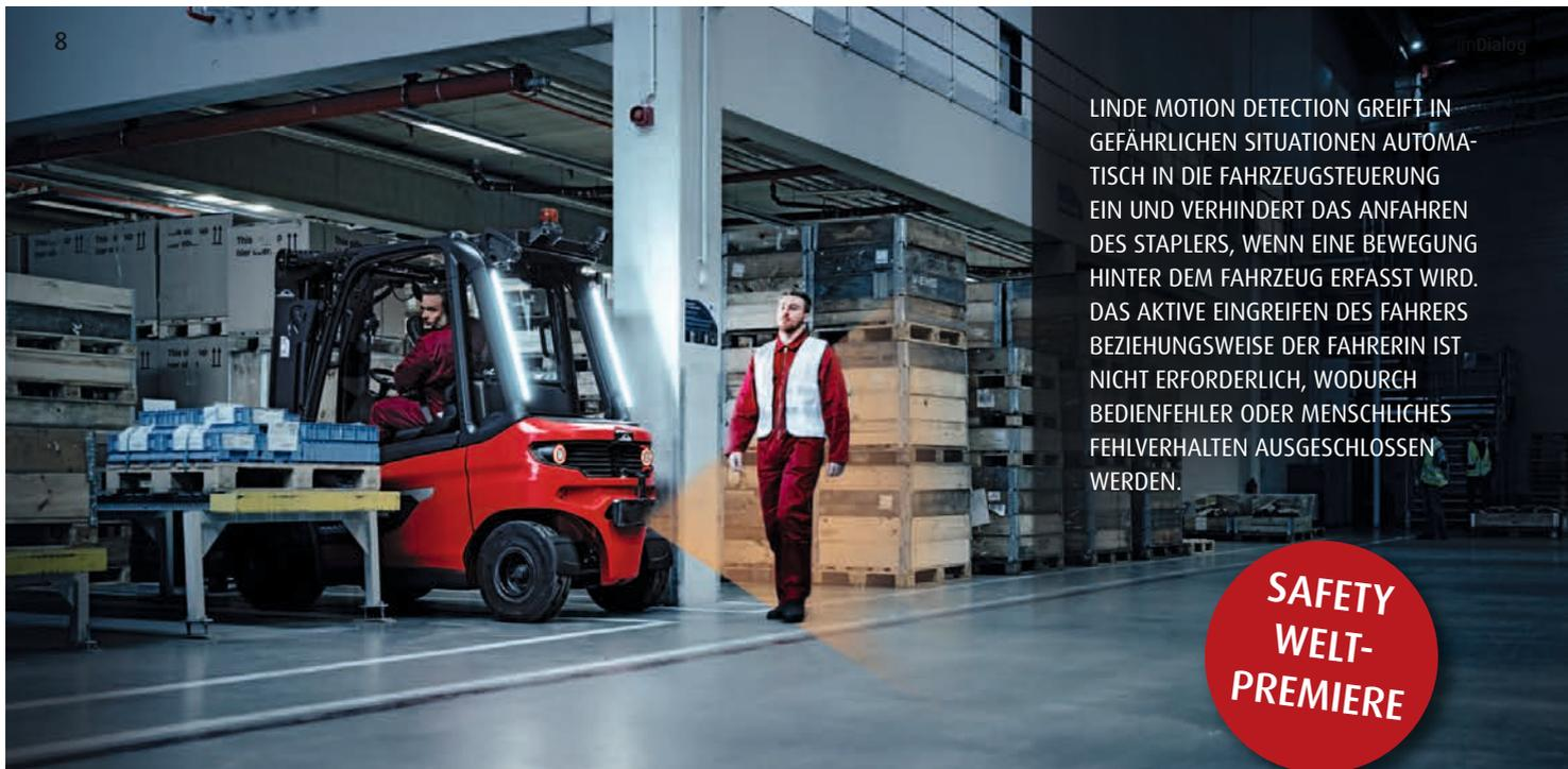
LINDE MOTION DETECTION GREIFT IN GEFÄHRLICHEN SITUATIONEN AUTOMATISCH IN DIE FAHRZEUGSTEUERUNG EIN UND VERHINDERT DAS ANFAHREN DES STAPLERS, WENN EINE BEWEGUNG HINTER DEM FAHRZEUG ERFASST WIRD. DAS AKTIVE EINGREIFEN DES FAHRERS BEZIEHUNGSWEISE DER FAHRERIN IST NICHT ERFORDERLICH, WODURCH BEDIENFEHLER ODER MENSCHLICHES FEHLVERHALTEN AUSGESCHLOSSEN WERDEN.
