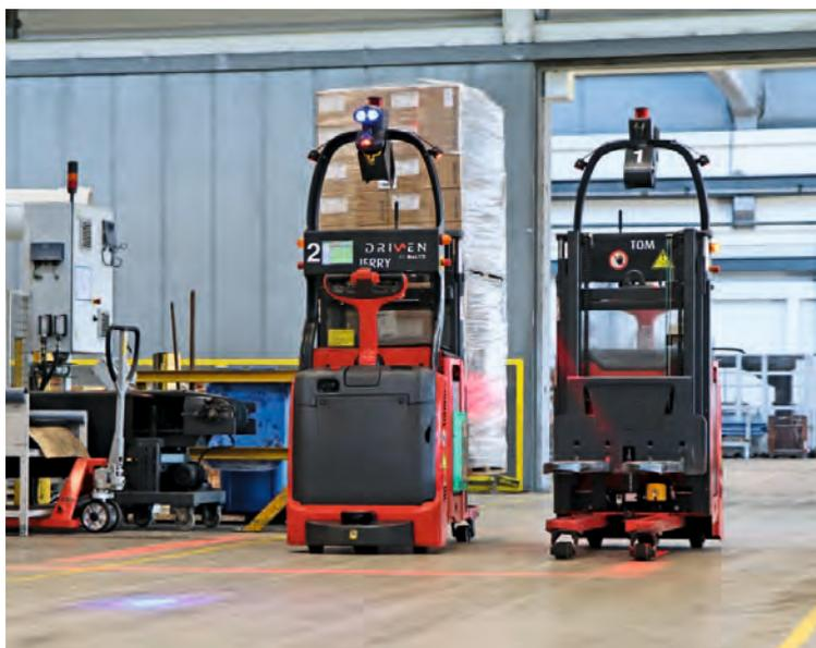
Die Linde L-MATIC entnehmen die palettierte Fertigware von der Verpackungsanlage (rechts) und transportieren sie ins 150 Meter entfernte Durchlauflager (links), wo sie die Fracht einlagern (unten).
