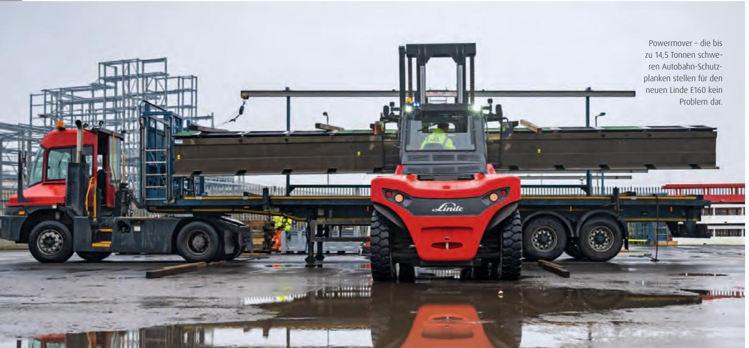
Powermover – die bis zu 14,5 Tonnen schweren Autobahn-Schutzplanken stellen für den neuen Linde E160 kein Problem dar.
