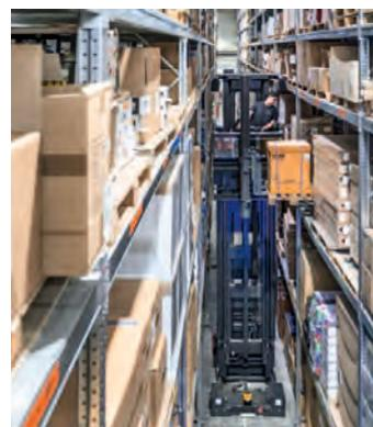
Das Linde-Assistenzsystem Dynamic Reach Control stabilisiert die K-Geräte seitlich beim Ausschleppen der Last.
